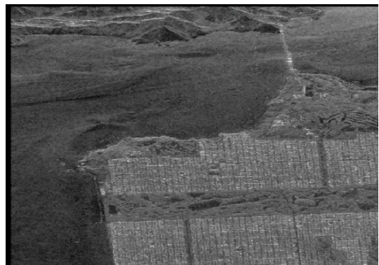
图5 自适应窗极化Lee滤波后的span图 (最小窗 3 \times 3 , 最大窗 11 \times 11 )
