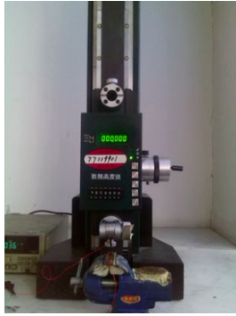
图3 复合材料大应变特性测试实物图
