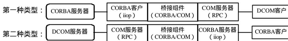
图3 桥接组件两种类型
