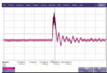
图3 ns光脉冲触发2mm开关输出波形
