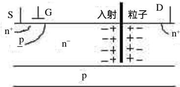
图1 横向高压DMOS器件结构
