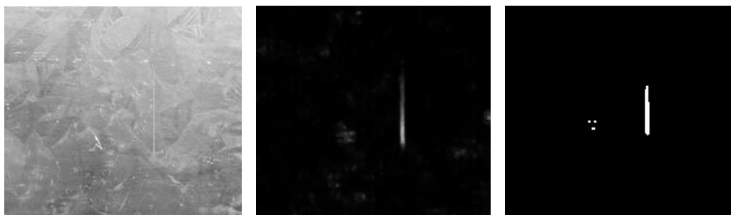
a 带单条竖条纹缺陷原图
