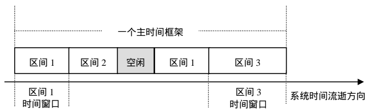
图3 基于时间窗的循环调度算法原理
