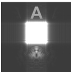
图7 博奇型修正离轴参考光计算全息图的再现像
