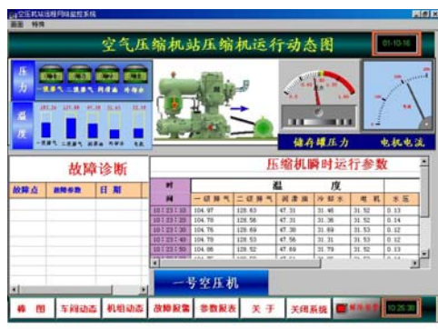
图3 空气压缩机站运行动态图
