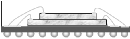
图1 金字塔叠层CSP封装形式
