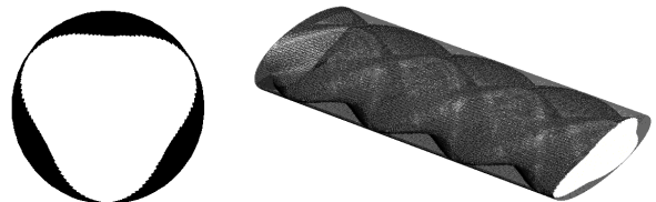
图1 内开槽螺纹波导的横截面及立体图
