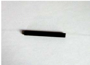
图2 粘接了线性啁啾光纤光栅的磁致伸缩棒
