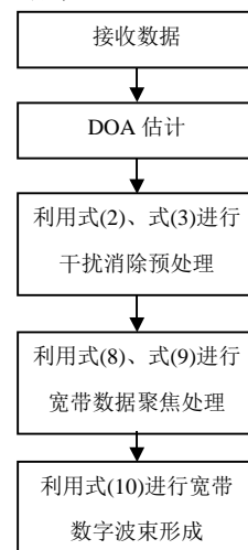
图1 存在主瓣干扰时的宽带波束形成处理流程
