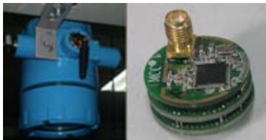
a. 标签外观 b. 标签内部电路硬件
