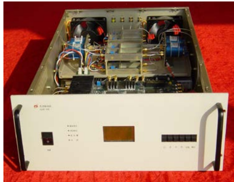
图6 600 Mb/s高速解调器实物照片
