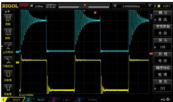
图11 TIBUCK变换器的开关管Q和二极管D所承受的电压 V_Q 和 V_D 的波形
