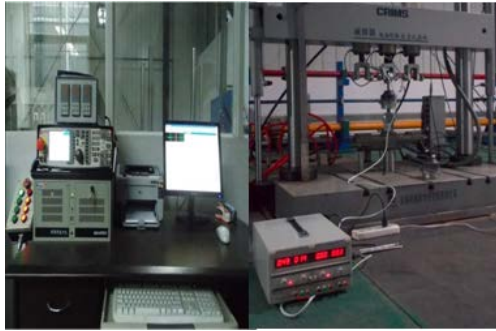
图3 磁流变悬置动态特性测试试验台
