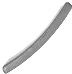
图4 轴向端面裂纹
