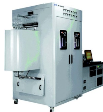
d. PRS-16多通道高速量反应器系统外观
