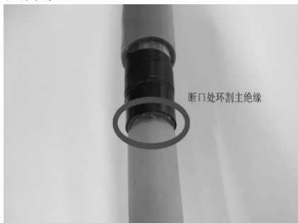
图7 电缆终端主绝缘割伤
