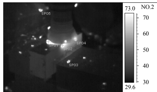
图6 热像仪测试磨面机工作温度结果
