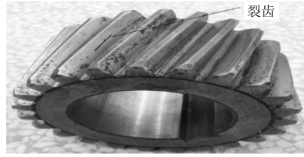
c. 裂齿故障配件
