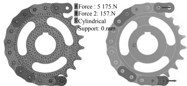
图2 链轮系统有限元模型及约束施加情况
