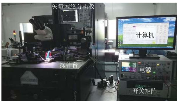
图 11 多功能芯片自动测试系统
