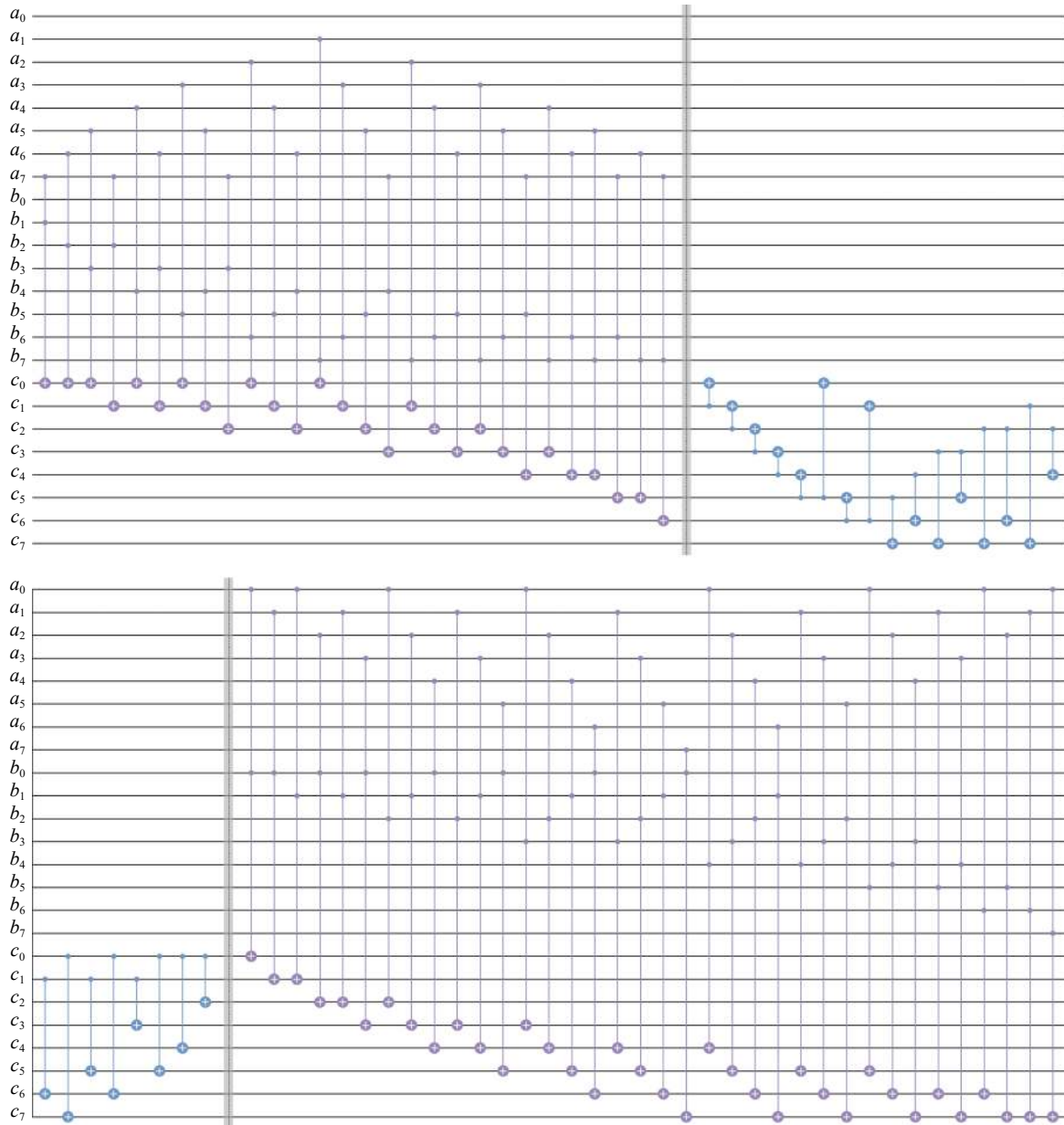
图 4 实现式 (18) 乘法计算的量子电路图
