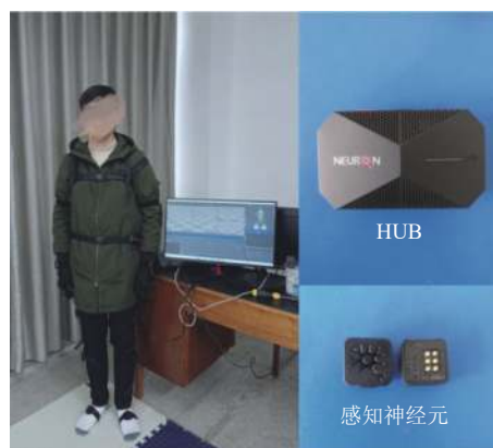
图 4 可穿戴式惯性动作捕捉系统 Perception Neuron 2.0
