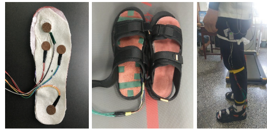
图 3 足底压力鞋垫和传感器位置固定示意图
