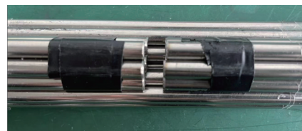
图 15 模拟截面积损失的钢丝束
